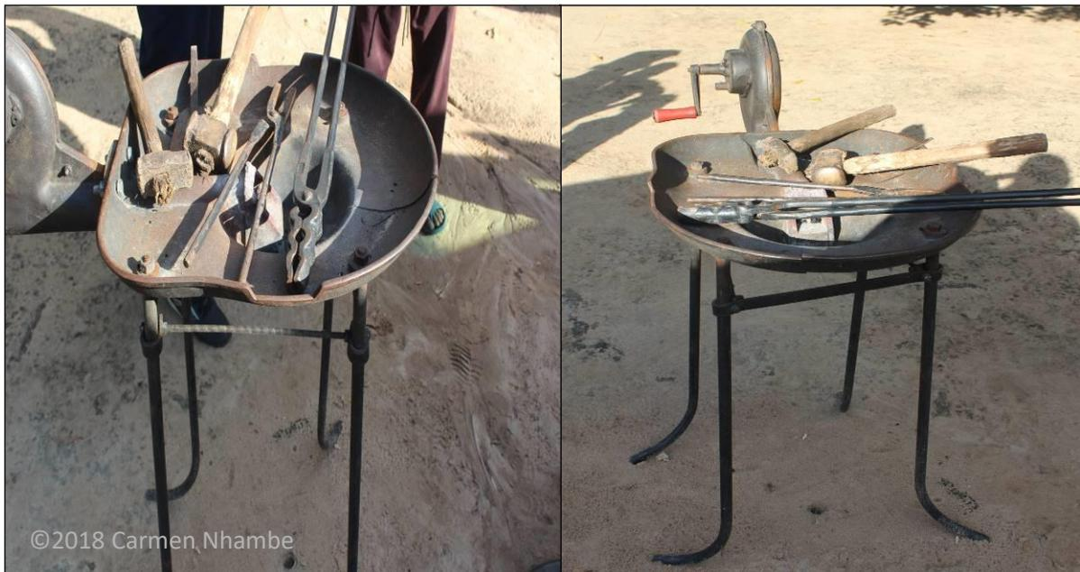
**Figura 16:** Forjadora para fundição e ferramentas para destruição dos instrumentos de caça. Os instrumentos de caça recolhidos na campanha foram manuseados pelo ferreiro moldando-o a quente ou a frio com a finalidade de dar-lhe uma forma de ferramentas agrícolas.
